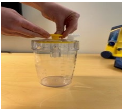
Bildet viser hvordan den gule vakuumforseglingen festes til lokket
