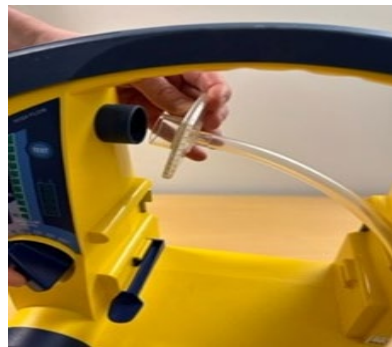
Bildet viser hvordan slangen med filter festes til vakuuminngangen på maskinen
